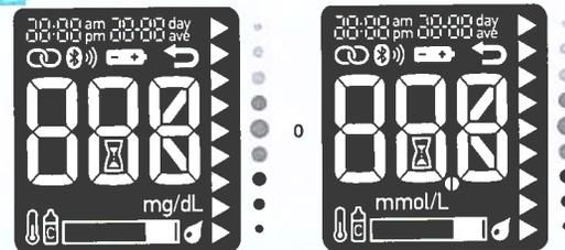
Pulse y mantenga pulsada la tecla del medidor hasta que aparezcan todos los segmentos de la pantalla. Compruebe que no faltan segmentos en la pantalla del medidor. Todos los segmentos deben verse como en la imagen de arriba. Si alguno de los segmentos no se ve en la pantalla, póngase en contacto con Roche; es posible que haya un problema con el medidor.
