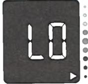
El nivel de glucemia puede estar por debajo del rango de medición del sistema.
