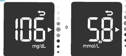
Con el medidor apagado, pulse la tecla del medidor para encender el medidor. El símbolo del último resultado de medición
