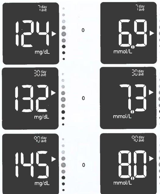
Con el medidor apagado, pulse la tecla del medidor para encender el medidor. Pulse la tecla del medidor para ver los promedios de 7, 30 y 90 días.
