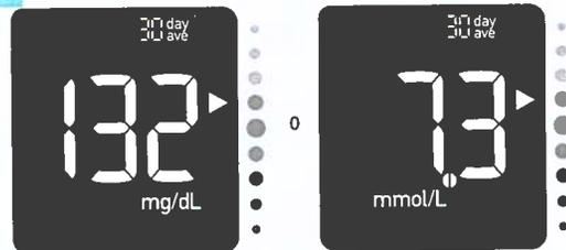
Con el medidor apagado, pulse la tecla del medidor para encender el medidor. Pulse la tecla del medidor dos veces para visualizar la pantalla del promedio de 30 días.
