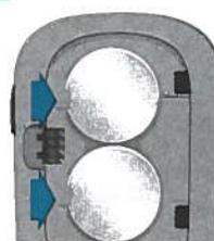
Deslice las pilas nuevas por debajo de las pestañas con el lado del símbolo (+) hacia arriba. Vuelva a colocar la tapa del compartimento de las pilas en su sitio y ciérrela de modo que encaje.
