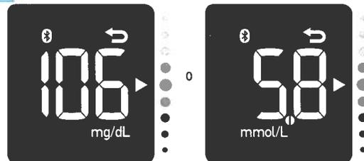
Con el medidor apagado, pulse la tecla del medidor para encender el medidor. Aparece la pantalla del último resultado de medición.
