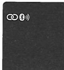
Con el medidor apagado, pulse y mantenga pulsada la tecla del medidor hasta que aparezca el símbolo de *Bluetooth*. El símbolo de sincronización y el símbolo de conexión inalámbrica aparecen y parpadean.
