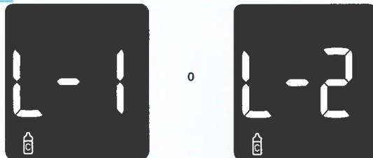
Si ha utilizado la solución de control del nivel 1, aparece la pantalla L-1. Pulse y mantenga pulsada la tecla del medidor para confirmar que ha utilizado la solución de control del nivel 1.
