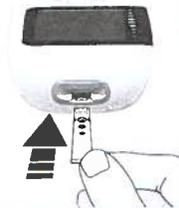
Inserte el extremo metálico de la tira reactiva en el medidor. El medidor se enciende.
