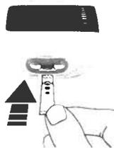
Inserte el extremo metálico de la tira reactiva en el medidor. El medidor se enciende.
