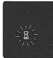
Cuando hay suficiente solución de control en la tira reactiva aparece el símbolo de un reloj de arena parpadeando.
