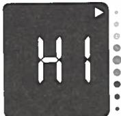
El nivel de glucemia puede estar por encima del rango de medición del sistema.
