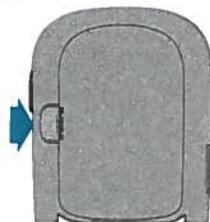
Abra la tapa del compartimento de las pilas en la parte posterior del medidor empujando la pestaña en la dirección de la flecha y levantando la tapa.
