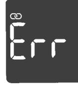
El medidor no ha podido sincronizarse con un dispositivo móvil.
