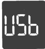
El medidor está conectado a un ordenador y no es posible realizar una medición de glucemia ni un control del funcionamiento.
