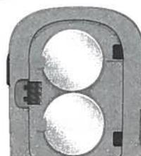
Retire las pilas usadas. Pulse y mantenga pulsada la tecla del medidor durante al menos 2 segundos.
