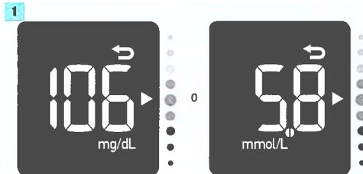
Con el medidor apagado, pulse la tecla del medidor para encender el medidor. Aparece la pantalla del último resultado de medición.
