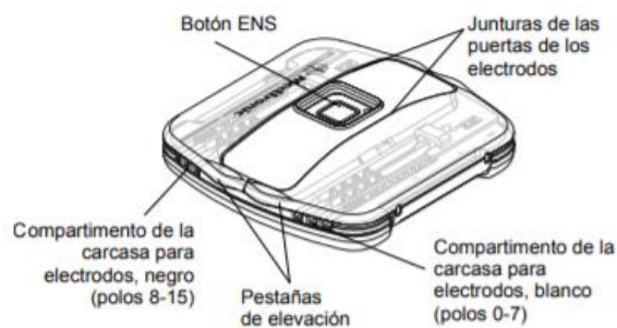
Figura 1. Neuroestimulador externo inalámbrico Modelo 97725 (puertas cerradas).
