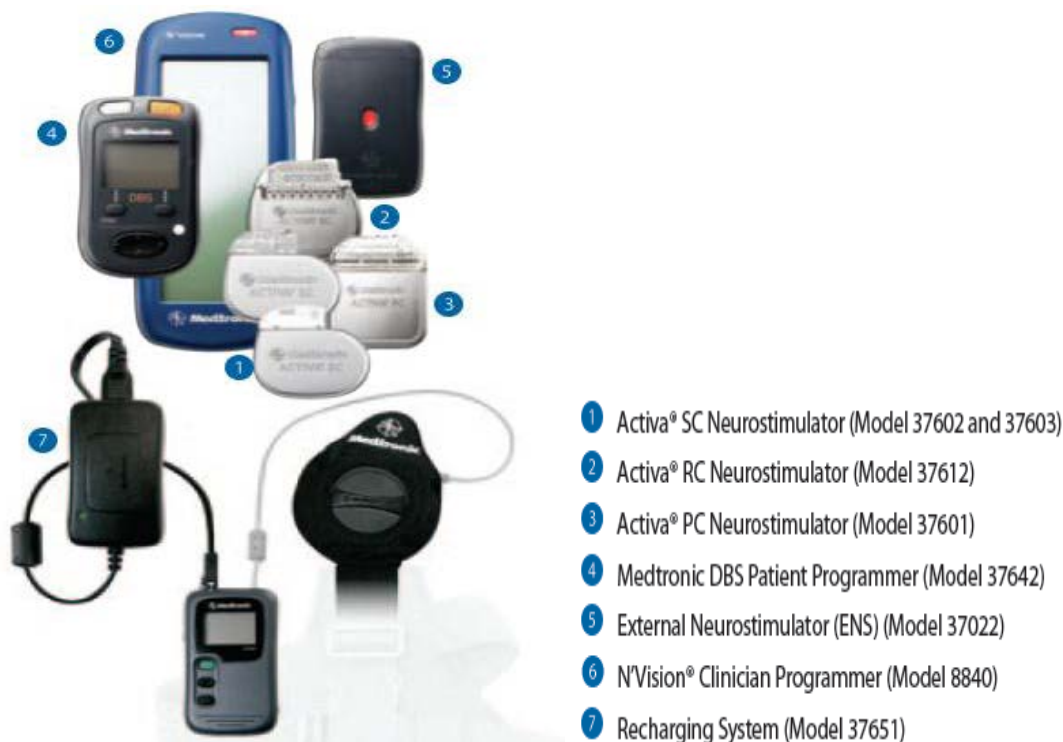
Imagen 1. Componentes del Sistema de Estimulación Cerebral Profunda ACTIVA®
