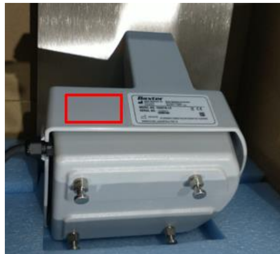
Imagen 2. Ubicacion de la placa en Celda de carga
