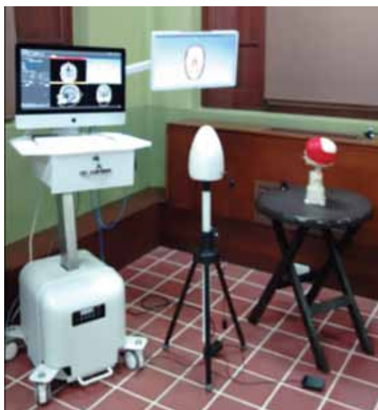
Figura 4. Simulador neuroquirúrgico Daubara NS-Trainer, en desarrollo actualmente por el grupo GIBIC, permite la simulación de procedimientos tales como toma de biopsias, resección de tumores, ventriculotomías, además de contar ejercicios para entrenar la viso-espacialidad.
